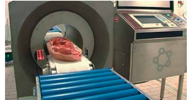
Abbildung 3.6.12: Schinkenbewertungssystem (JMP Ingenieros, S.L., Sotés, La Rioja, Spain)
