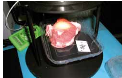
Abbildung 3.4.3: Analyse von Schweinefleisch mithilfe von NIRS
