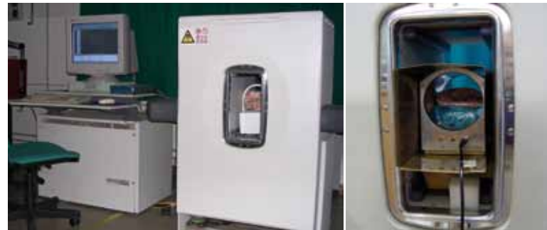
Abbildung 3.6.11: MRI Apparat ARTOSCAN (links) und die für die Relaxometrie geeignete Spule (rechts).
