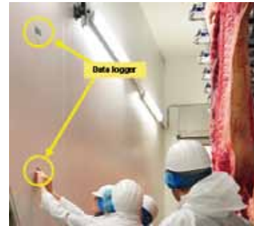
Abbildung 3.8.1: Temperaturkartierung im Kühlraum
